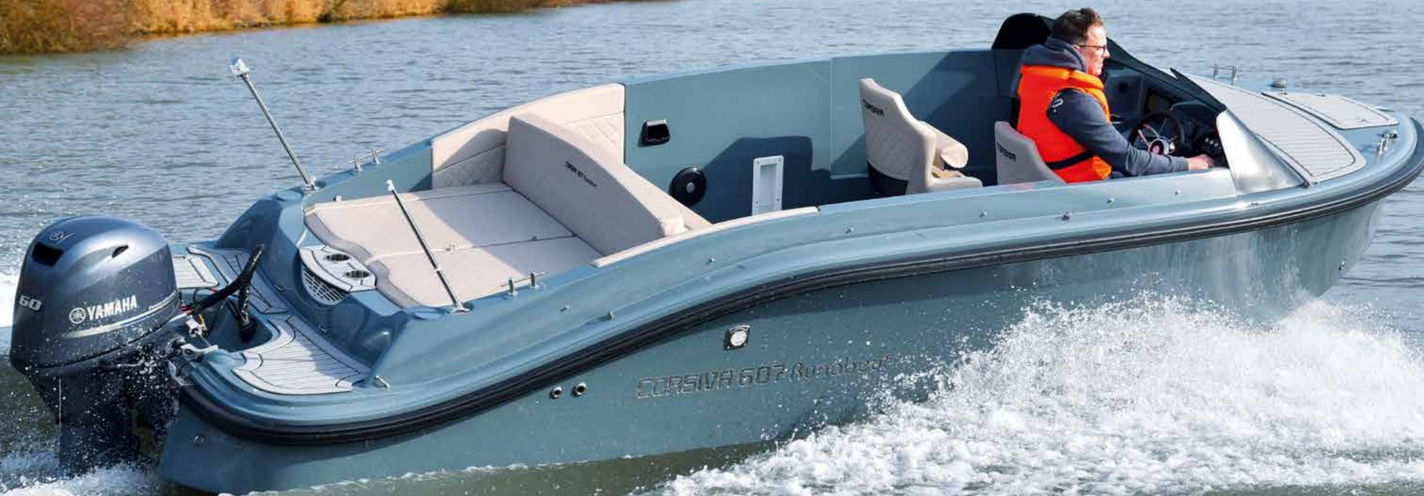
Schon mit dem vierzylindrigen Yamaha F60 am Heck fährt die Corsiva 607 Runabout recht gut vorwärts. Die auf dem Datteln-Hamm-Kanal ermittelte Spitzengeschwindigkeit beträgt 21 kn
